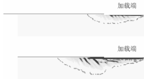
图 5：外贴 FRP 下混凝土裂缝的发展过程 [4]
