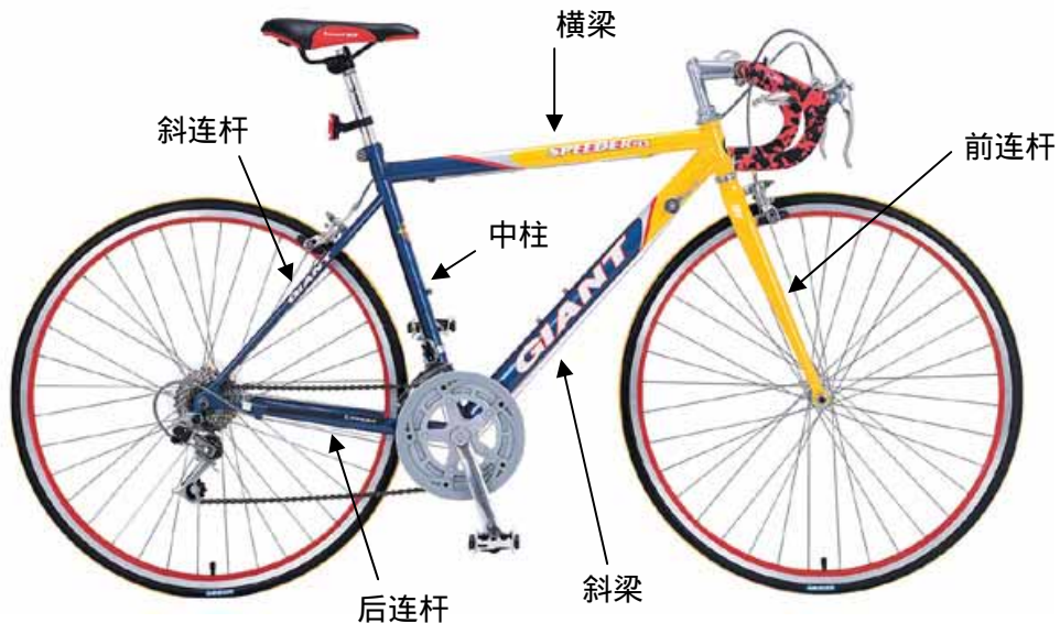
图 1 自行车杆系骨架命名约定
